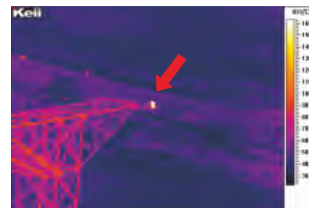
XXX线0104号塔右地线小号右侧放电间隙发热，发热点温度159.6度，正常温度26.4度，高133.2度
