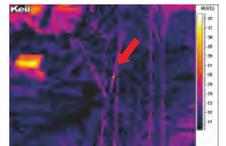
XXX线0038号塔上导线左V串导线端绝缘子发热，发热点温度32.54度
