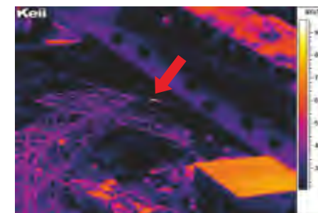
XXX线0091号塔左地线大号侧调整板发热，发热点温度95.79度
